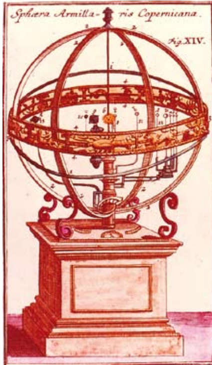
Väritetty kuparipiirros vuodelta 1769. Piirros esittää mekaanista planetaariota, joka kuvaa Kopernikuksen aurinkokeskistä maailmanmallia.
